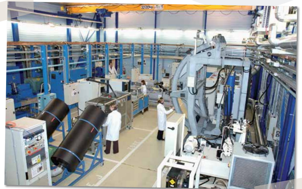
Outil exceptionnel, le banc d'essai Copper Bird® installé à Colombes joue un rôle central dans la mise au point de l'avion « plus électrique » par Safran et ses partenaires.
