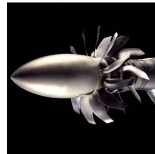
Pales de l'open rotor lors d'essais en soufflerie.
